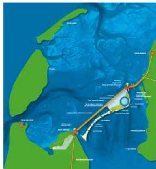
Een goed voorbeeld van energie en ruimtelijk ontwerp. In ontwerpsenario's voor de versterking van de Afsluitdijk hebben in 2008 vier teams van ontwerpers en ingenieurs gekeken of de dijk een rol kan spelen bij het opwekken van duurzame energie door windmolens, het benutten van de getijden en de overgang van zoet naar zout water.
