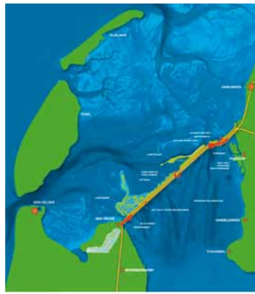
Een goed voorbeeld van energie en ruimtelijk ontwerp. In ontwerpsenario's voor de versterking van de Afsluitdijk hebben in 2008 vier teams van ontwerpers en ingenieurs gekeken of de dijk een rol kan spelen bij het opwekken van duurzame energie door windmolens, het benutten van de getijden en de overgang van zoet naar zout water.
