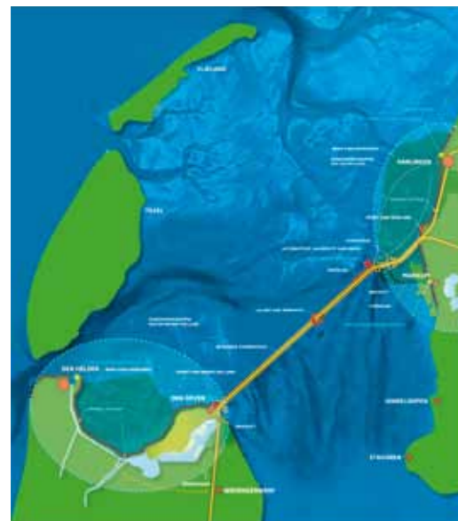
Een goed voorbeeld van energie en ruimtelijk ontwerp. In ontwerpsenario's voor de versterking van de Afsluitdijk hebben in 2008 vier teams van ontwerpers en ingenieurs gekeken of de dijk een rol kan spelen bij het opwekken van duurzame energie door windmolens, het benutten van de getijden en de overgang van zoet naar zout water.
