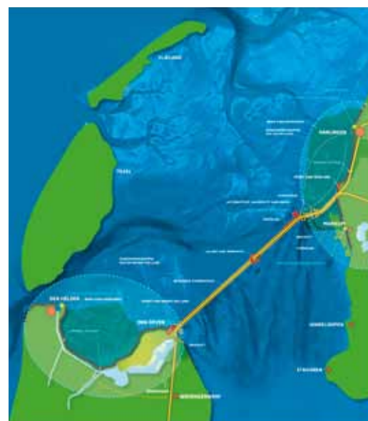
Een goed voorbeeld van energie en ruimtelijk ontwerp. In ontwerpscenario's voor de versterking van de Afsluitdijk hebben in 2008 vier teams van ontwerpers en ingenieurs gekeken of de dijk een rol kan spelen bij het opwekken van duurzame energie door windmolens, het benutten van de getijden en de overgang van zoet naar zout water.
