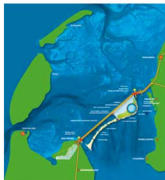
Een goed voorbeeld van energie en ruimtelijk ontwerp. In ontwerpscenario's voor de versterking van de Afsluitdijk hebben in 2008 vier teams van ontwerpers en ingenieurs gekeken of de dijk een rol kan spelen bij het opwekken van duurzame energie door windmolens, het benutten van de getijden en de overgang van zoet naar zout water.
